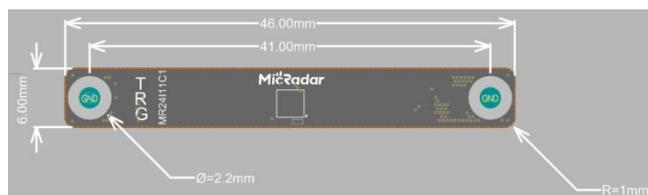
2) 固定方式：两侧螺钉孔
